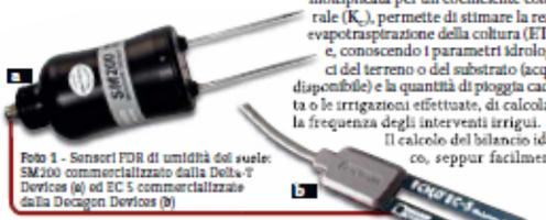
Foto 1 - Sensori FDR di umidità del suolo: SM200 commercializzato dalla Delta T Device (a) ed EC5 commercializzato dalla Decagon Device (b)
